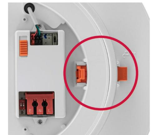
Die Montage des Leuchtkörpers an der Wand- oder Deckenhalterung erfolgt über zwei verdeckte Drucktaster. Mittels aufschiebbarer Schutzkappen wird eine werkzeuglose Demontage im öffentlichen Raum vermieden.
